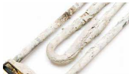
topné těleso s usazeninami
